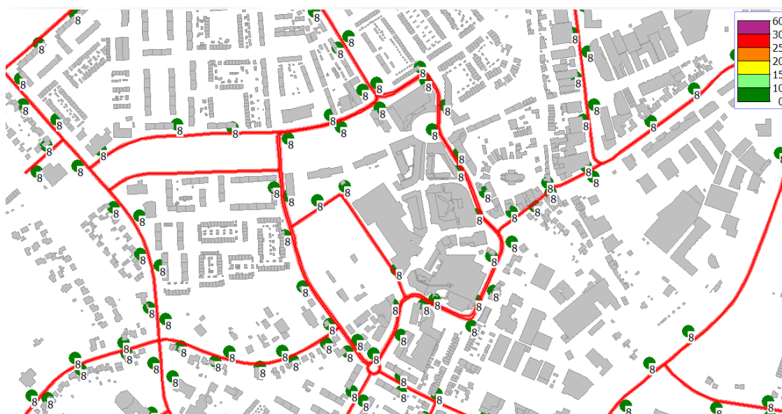
figuur 51: concentratie fijnstof (PM 2.5 ) in het centrum van Ridderkerk bij de tweerichtingsvariant met woningbouwontwikkeling
