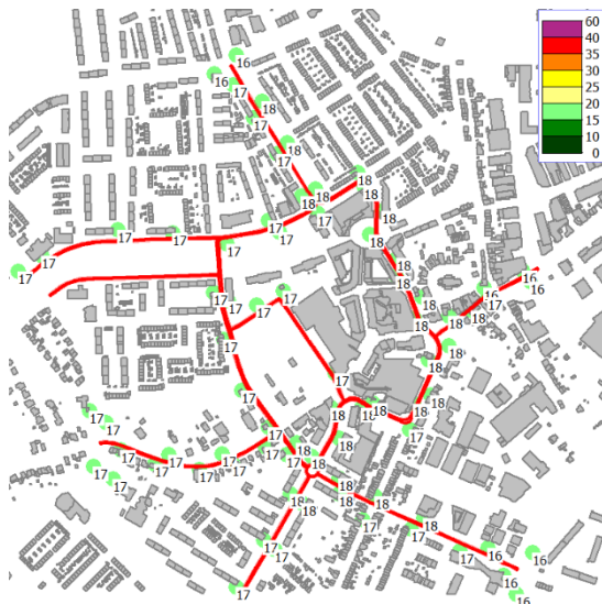
figuur 55: concentratie stikstofdioxide (NO 2 ) in het centrum van Ridderkerk bij de tweerichtingsvariant zonder woningbouwontwikkeling
