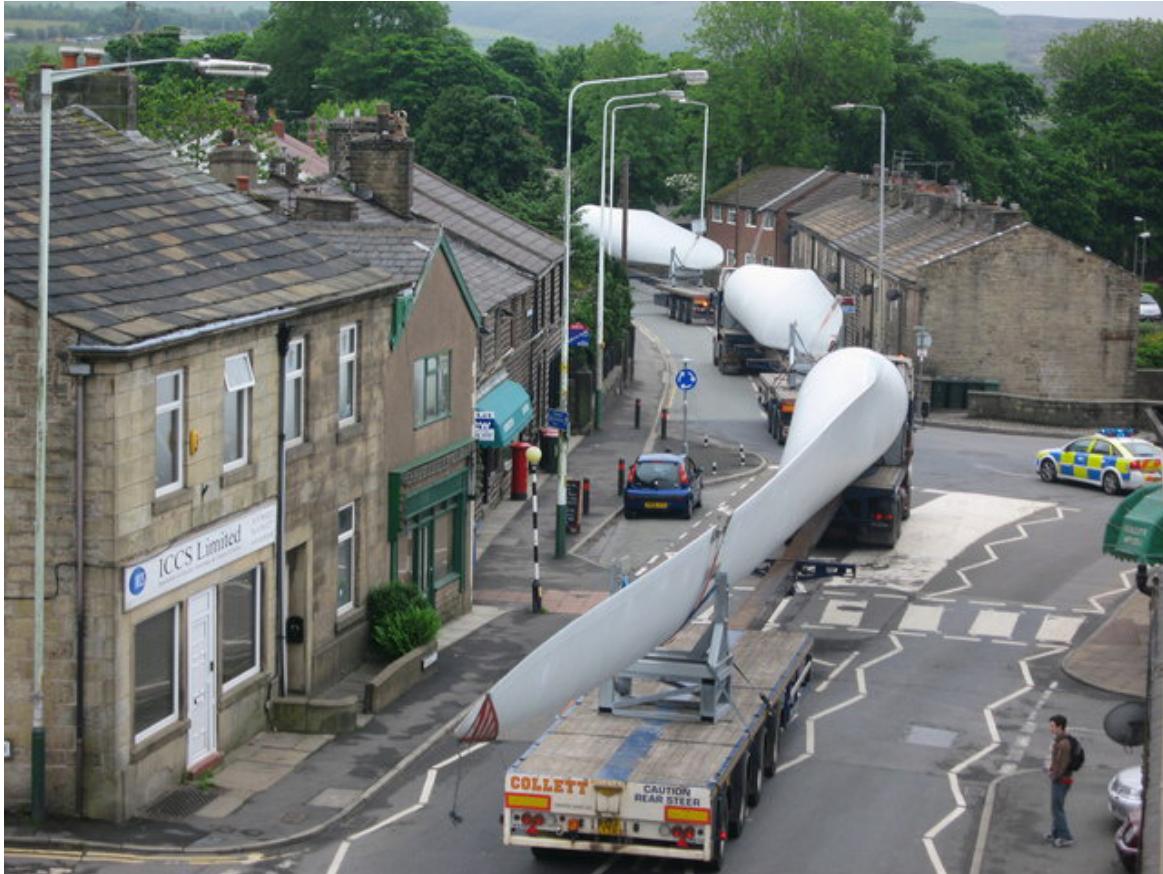
Afbeelding 12 Transport van 40 meter lange rotorbladen in Edensor (Verenigd Koninkrijk) 26
