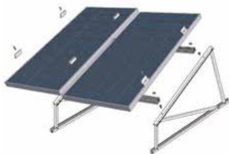
Afbeelding 5 en 6 Verhoogd, losstaand montagesysteem voor grindballast
