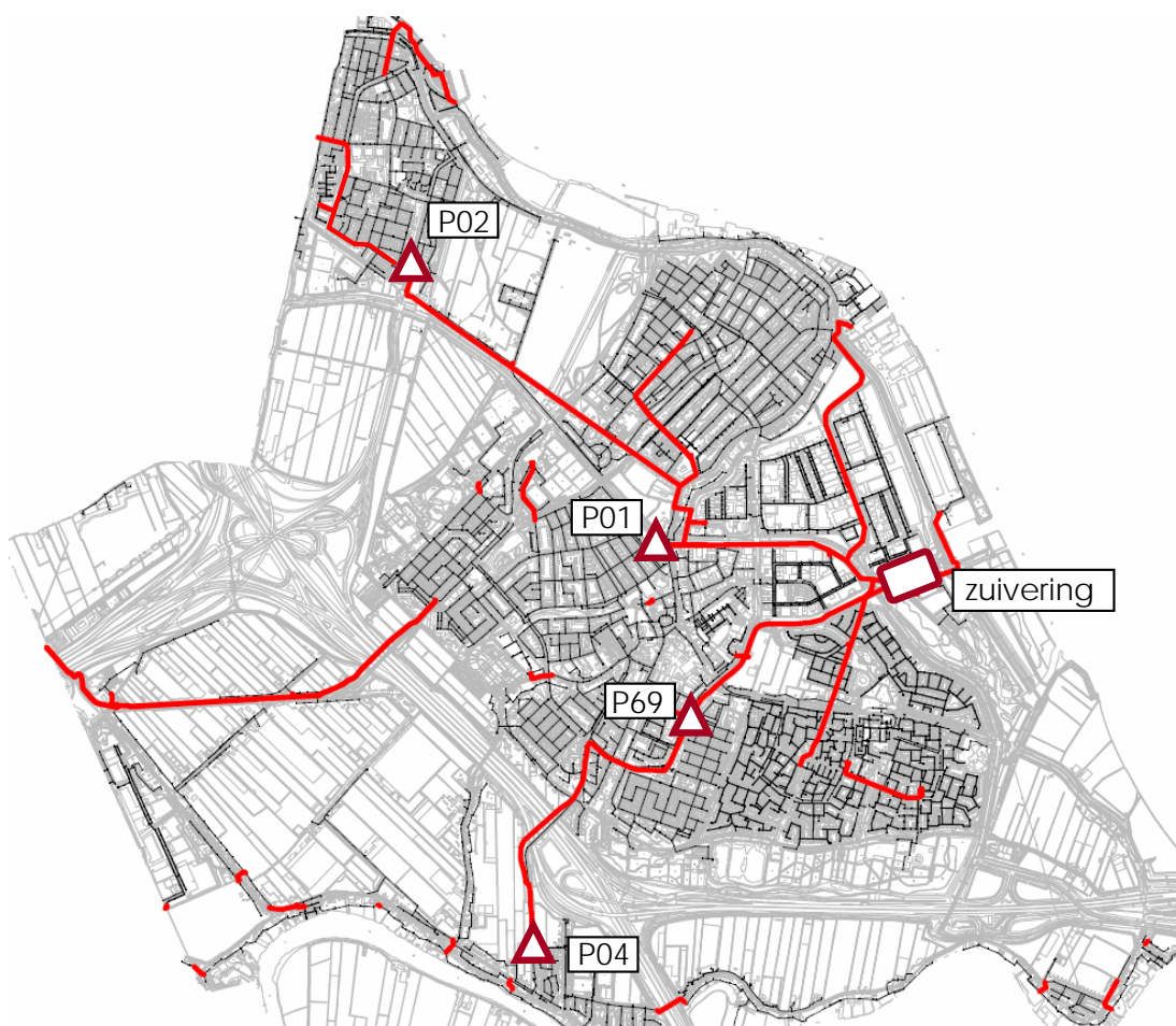
Figuur 1: Persleidingstructuur Ridderkerk
