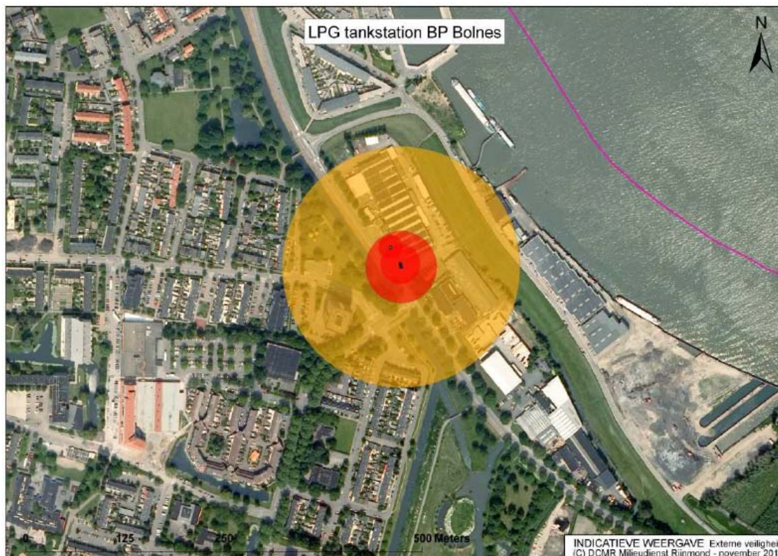
Figuur 4.5 PR 10-6 contour (rood) en invloedsgebied groepsrisico (geel) LPG tankstation BP Bolnes (bron: beleidsvisie externe veiligheid Ridderkerk)
