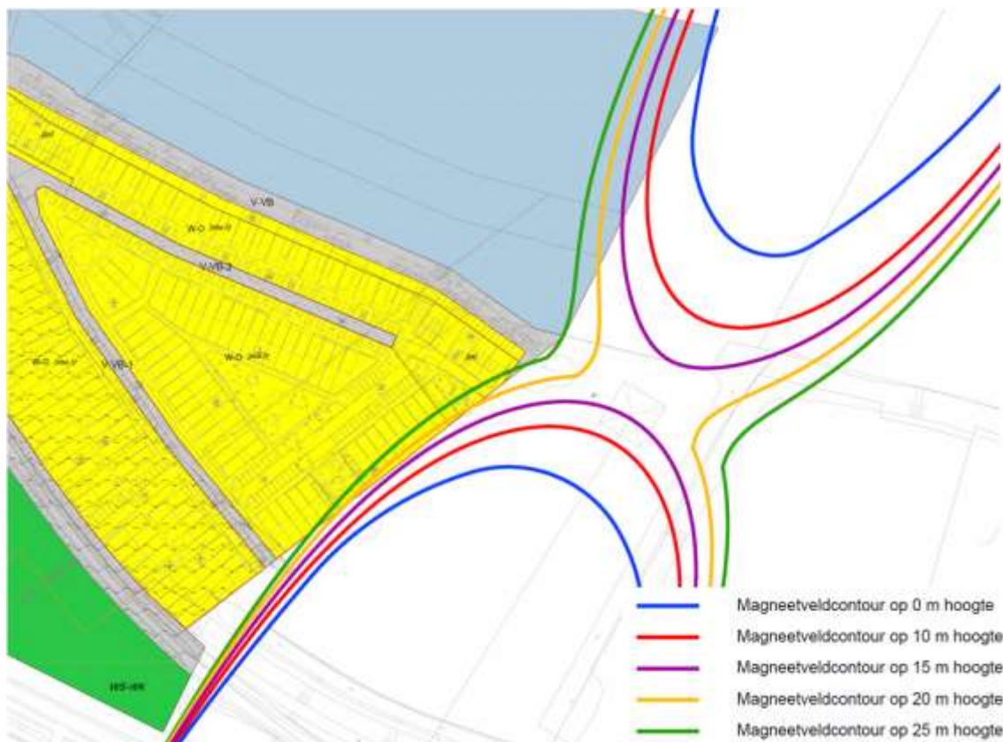
Figuur 4.7 Ligging 0,4 microTesla magneetveldcontouren volgens uit 3D-model berekeningen (bron: Kema)
