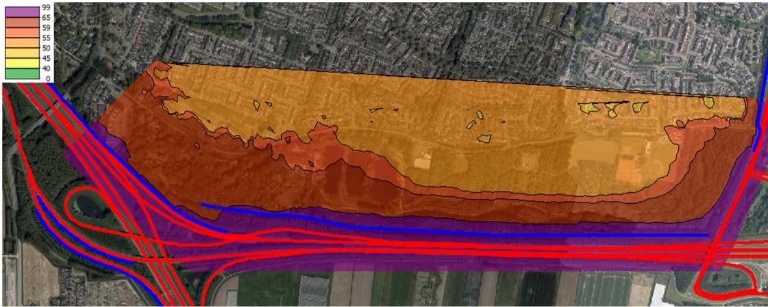
figuur 3: geluidcontouren ( L_{den} in dB) voor situatie volgens haalbaarheidsonderzoek met scherm 6 m/1.700 m (referentie N2)
