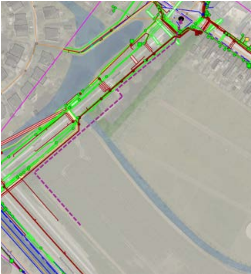
Figuur 4.6 Schetsontwerp indicatief tracé persleiding inclusief kabels en leidingen (KLIC d.d. 11 juli 2025)
