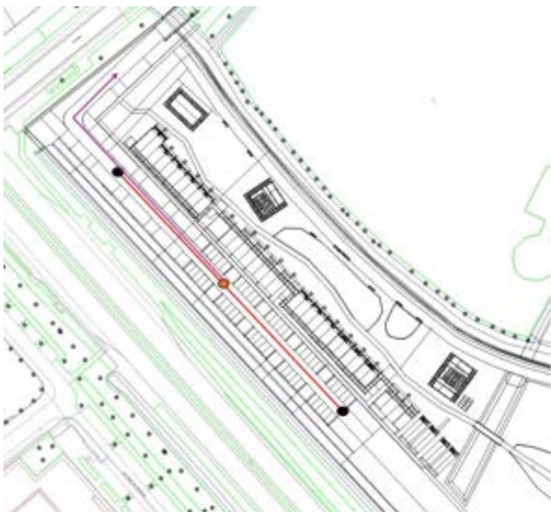
Figuur 4.5 Schetsontwerp vrijverval riolering (rode lijn) Flexwonen
