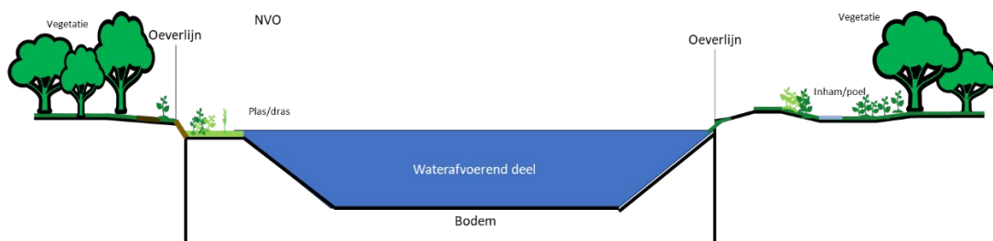
Figuur 9 Schematische weergave water voor ecologie met een natuurvriendelijke oever.
