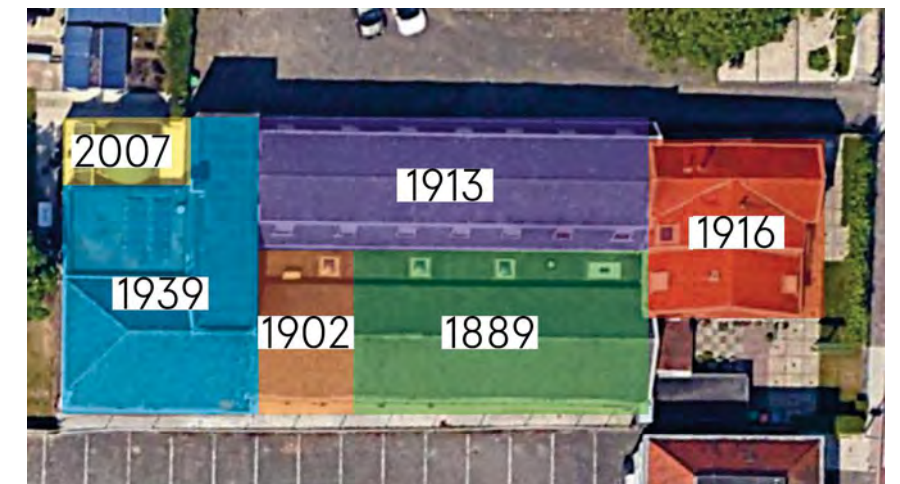
Uitbreiding van het schoolgebouw in verschillende fases
