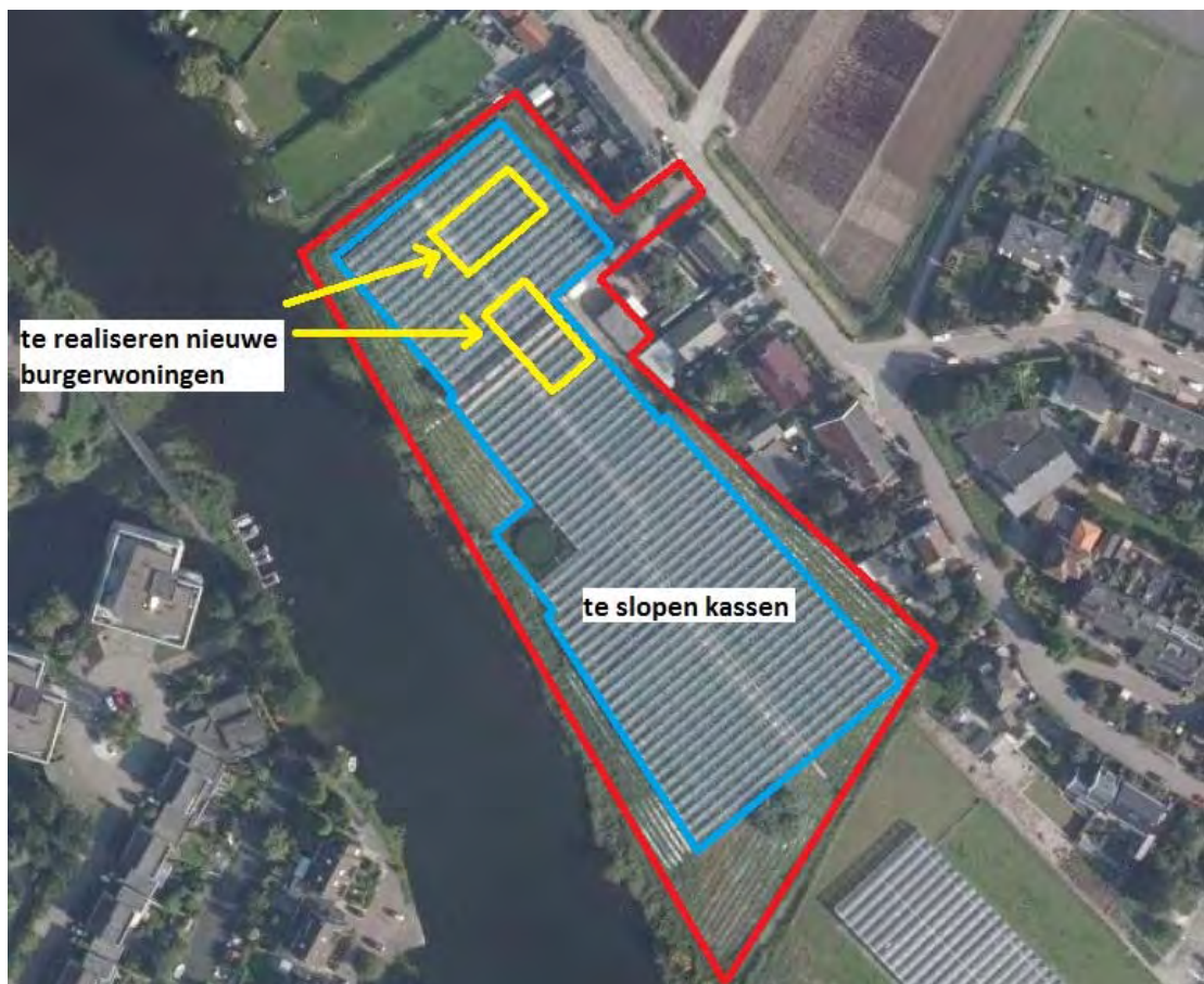
Figuur 3.1 Overzicht te slopen kassen en te realiseren woningen
