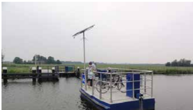
Een tweetal trekpuntjes versterken het recreatieve routenetwerk. De kabels moeten wel voldoende diep liggen.
