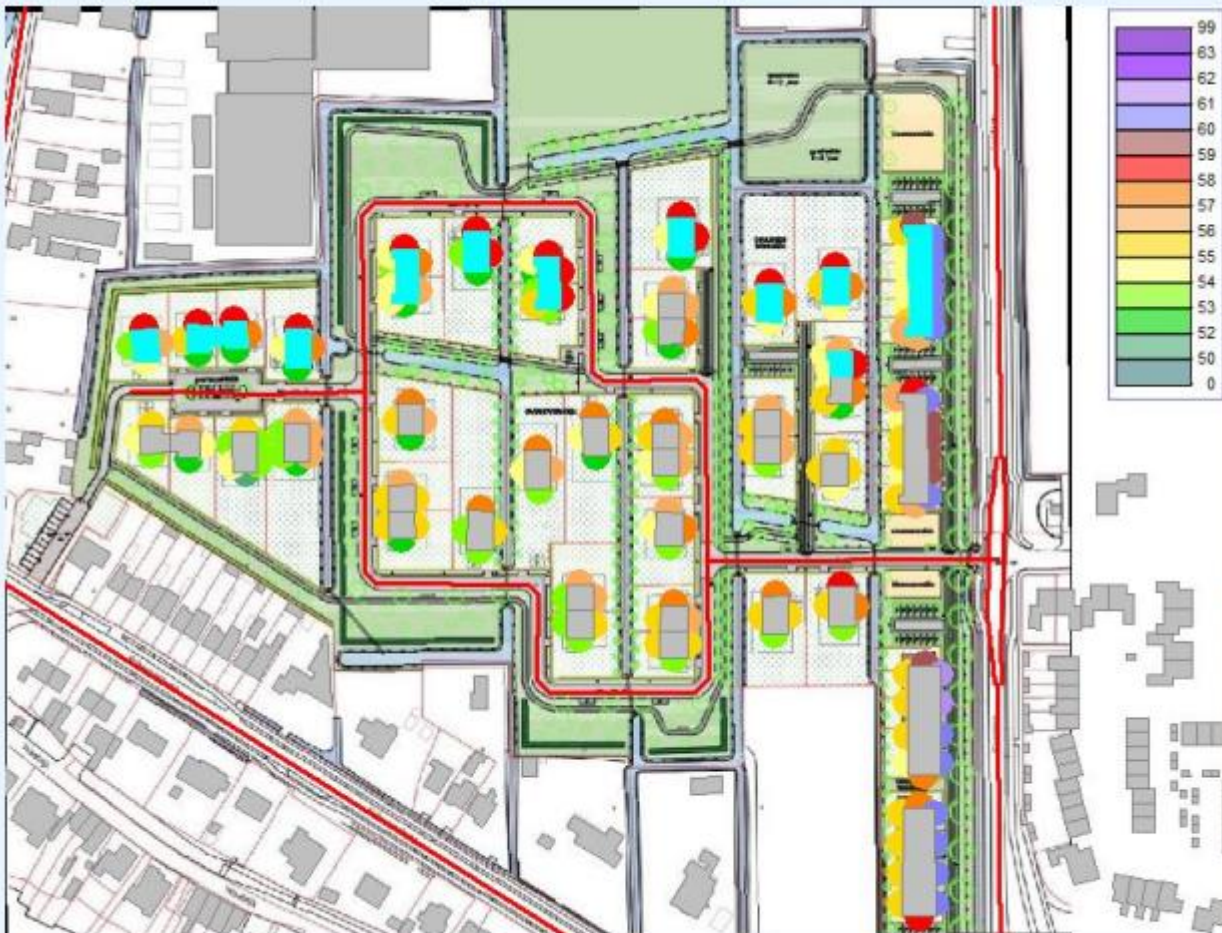
figuur 17: cumulatieve geluidsbelasting ( L_{den} in dB zonder aftrek) met beoordeling geluidluwe gevel (lichtblauw gekleurde woningen vallen onder Interimwet Stad- en Milieubebod)
