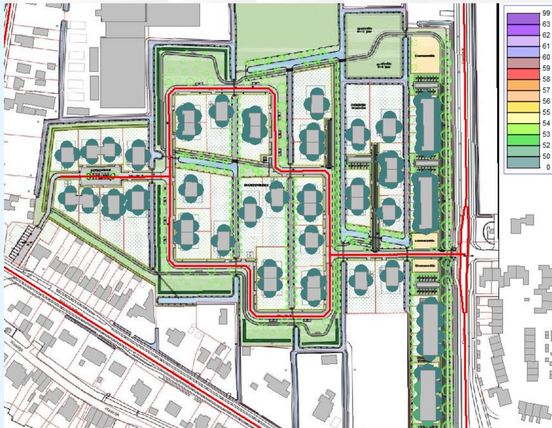
figuur 15: geluidsbelastingen vanwege Rijksstraatweg in dB L den (zonder aftrek artikel 110g Wgh)
