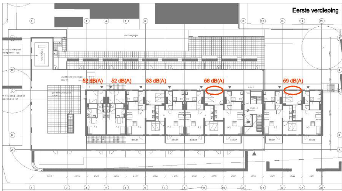
Figuur 4.1: Overzicht berekend stemgeluid - eerste verdieping bouwplan J.S. Bachstraat 4
