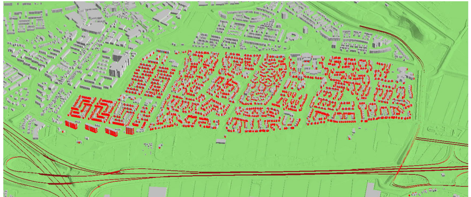
3D weergave van het opgestelde model (gebouwen zijn grijs weergegeven en de rekenpunten zijn rood)
